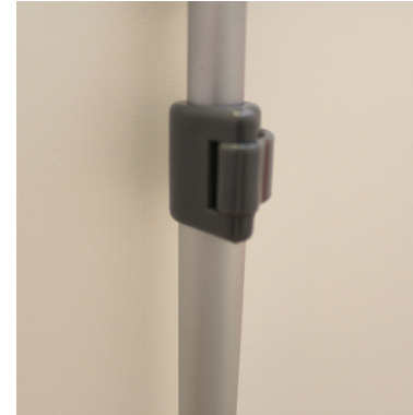
Die Arretierung der Teleskopstange lsen und den oberen Teil der...
